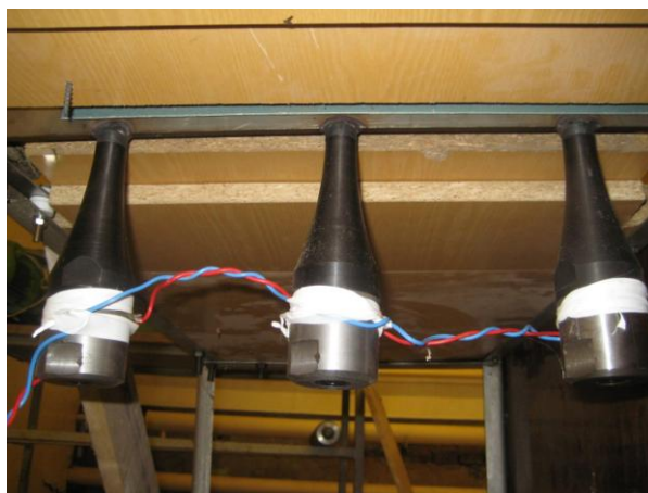
Рис. 3. Ультразвуковые излучатели и нож
