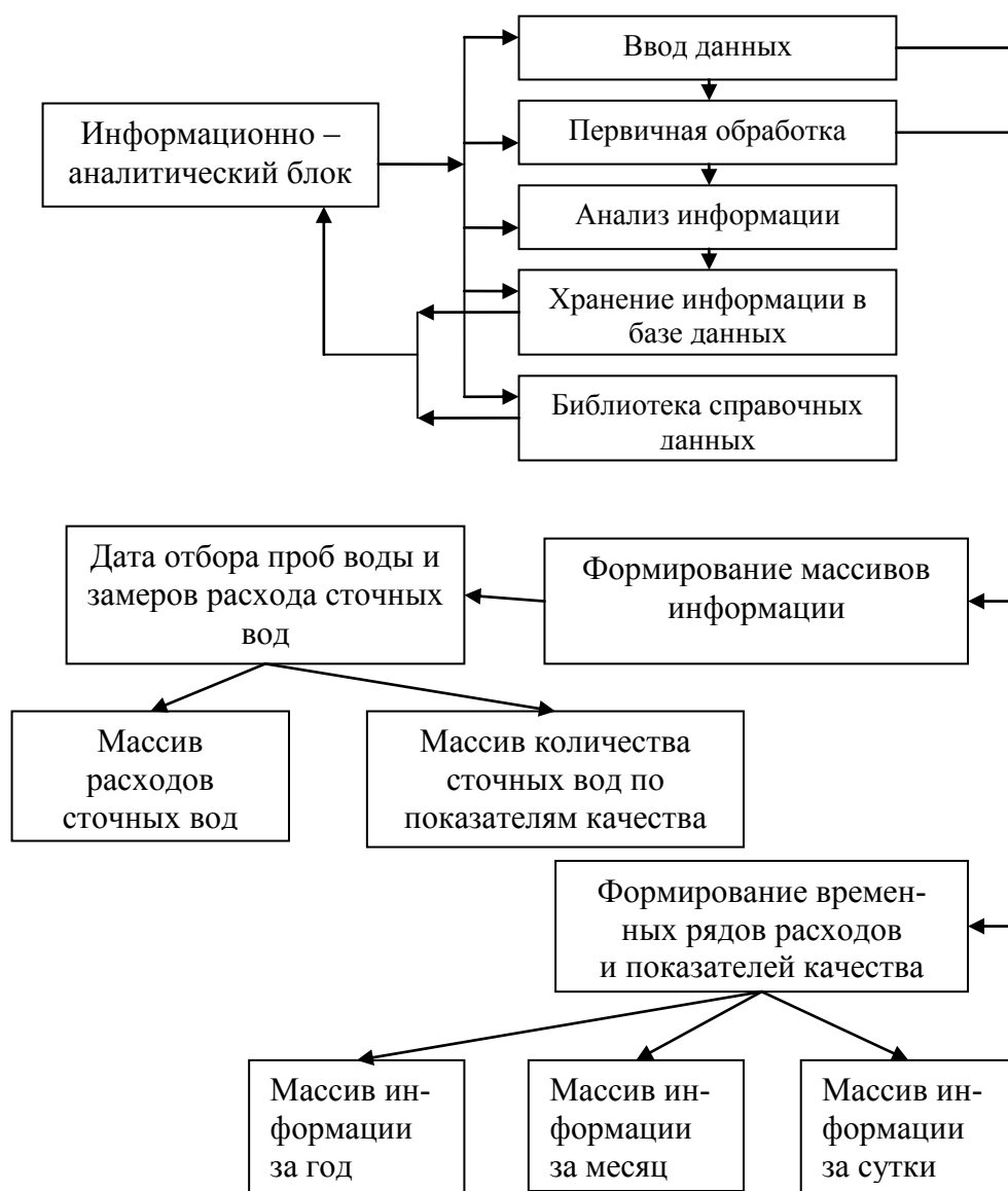
Рис. Блок-схема информационной технологии управления стоками
