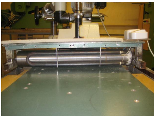
Рис. 2. ТЭН, нагревательный ролик и стол установки
