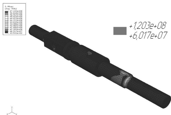
Рис. 1.18. Величина внутренних напряжений и сил резаний
