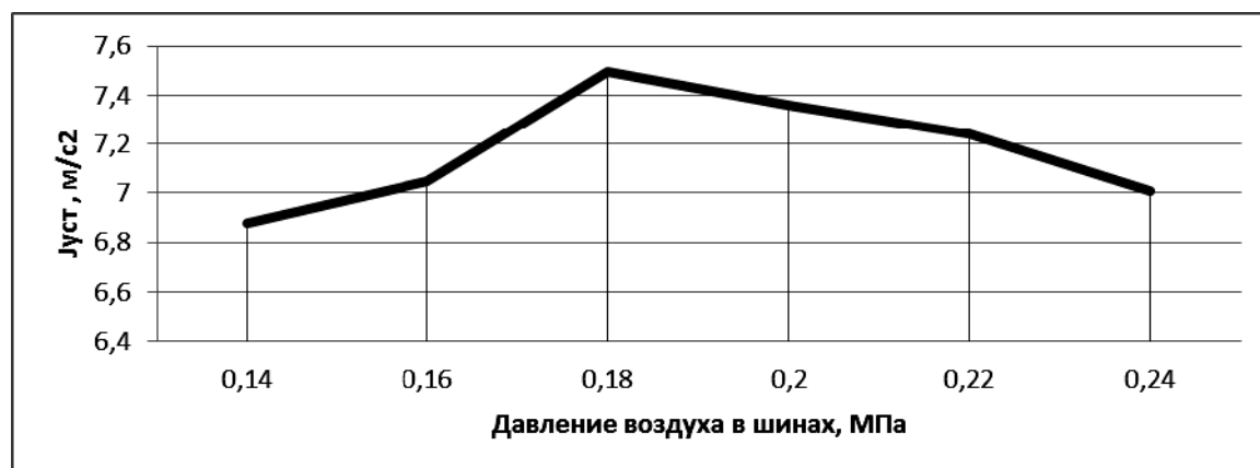
Рис. 3. Зависимость установившегося замедления АТС от давления воздуха в шине
