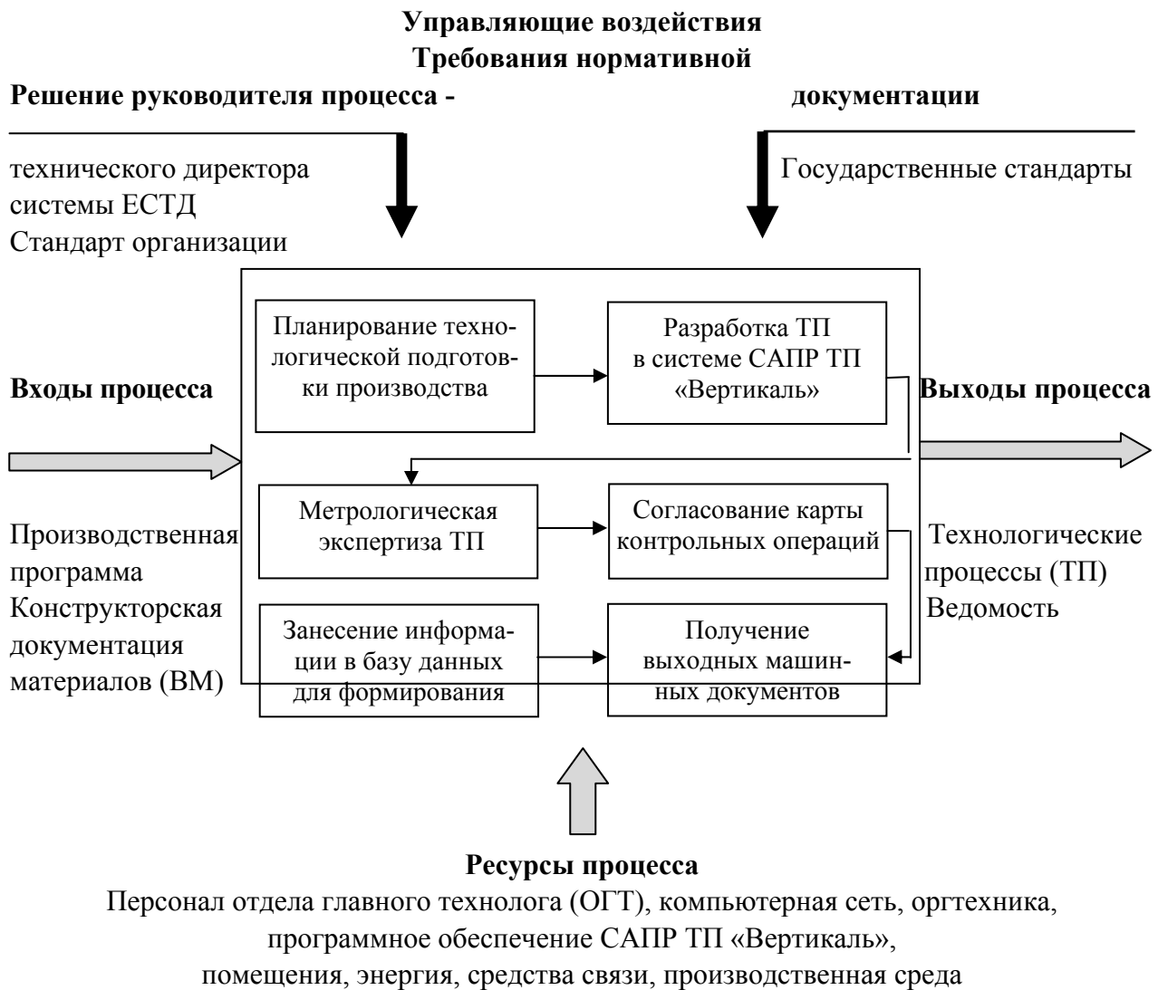
Рис. 2. Графическая схема процесса СМК О8 «Технологическая подготовка производства»
