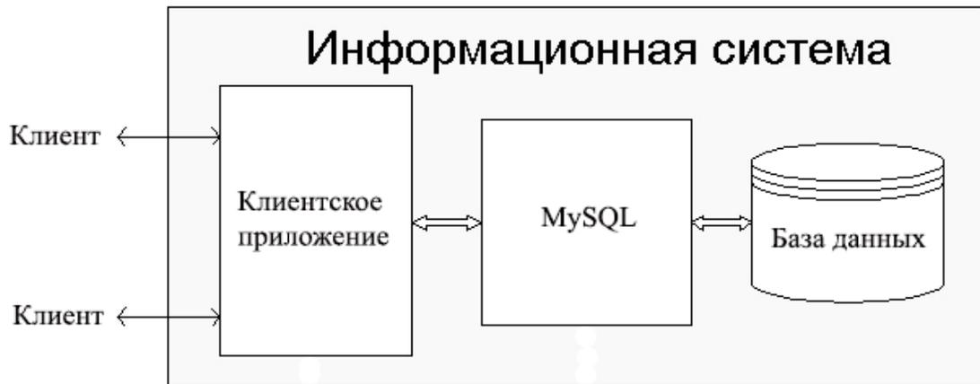
Рис. 1. Структурная схема информационной системы
