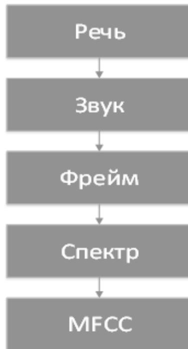
*Рис. 1. Схема преобразования речи*
