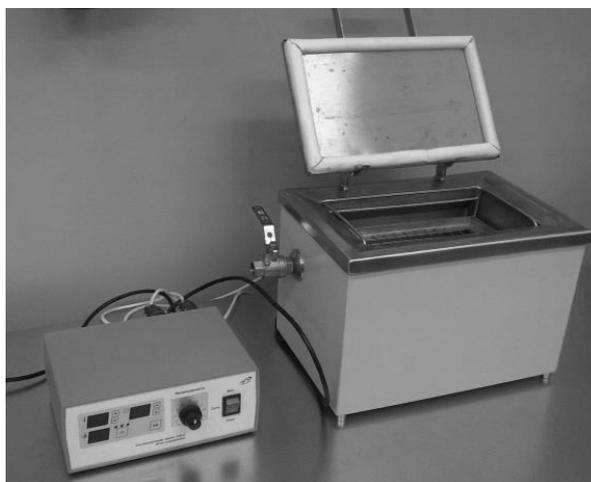
Рис. 4. Ультразвуковая ванна и блок управления
