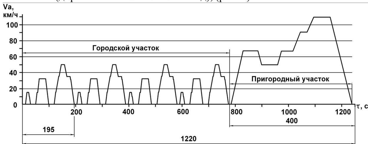
Рис. 1. Стандартный Европейский ездовой цикл испытаний автомобилей на токсичность
