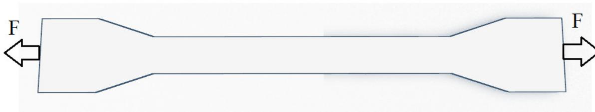
Рис. 1. Схема нагружения 3D-печатного образца в эксперименте
